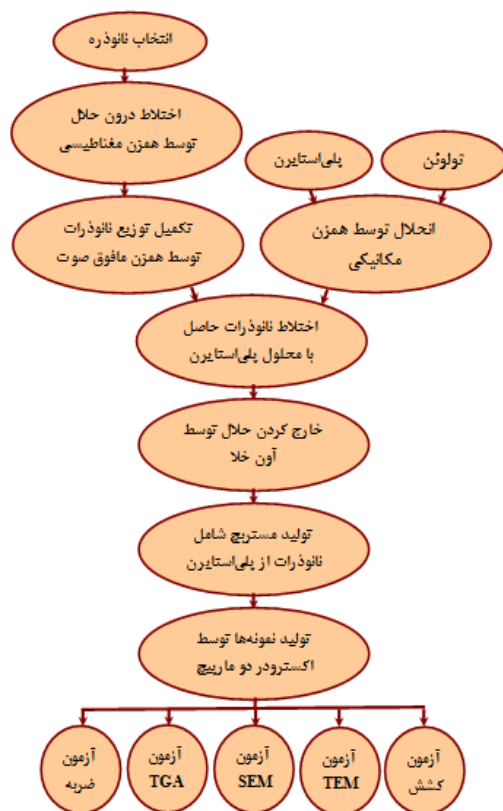
شکل ۱: مراحل مختلف تهیه نمونه‌های نانوکامپوزیتی و آزمون‌های صورت گرفته.
