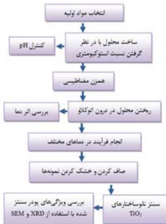
شکل ۲: فلوجارت تهیه نانوساختارهای \text{TiO}_2 به روش هیدروترمال.
