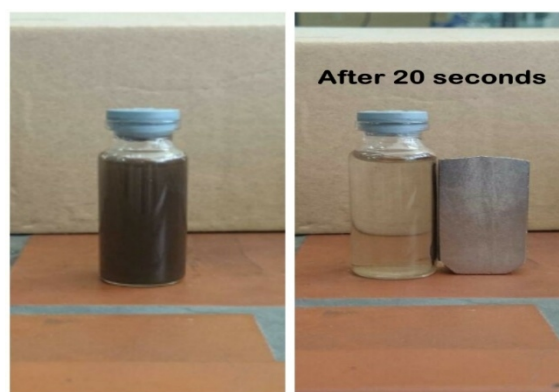
شکل ۴: جداسازی نانوذرات مغناطیسی هسته-پوسته Fe_3O_4@MnO_2 از محلول آبی با کمک آهنربا.
