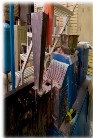
شکل ۲: تصویر دستگاه اکسترودر بکار رفته در تولید نانوکامپوزیت.
