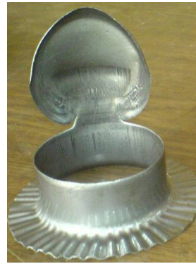
شکل (۶): پارگی در قطر ۱۰۱ mm
