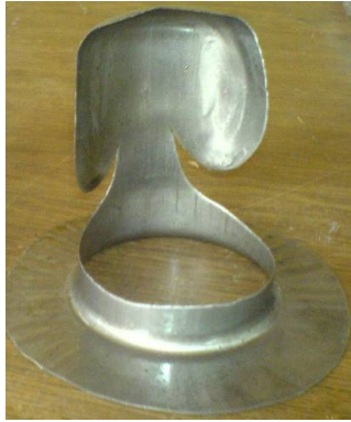
شکل (۷): پارگی در قطر ۱۰۲ mm
