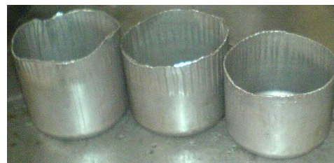
شکل (۸): فنجانهای کشیده شده با قطرهای ۱۰۴ mm و ۱۰۱ mm و ۹۶ mm
