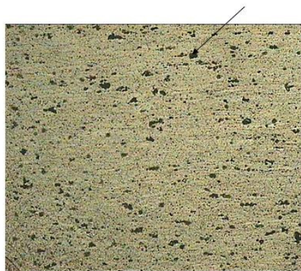
شکل (۷): تصویر ذرات TiO_2 در کامپوزیت ایجاد شده
