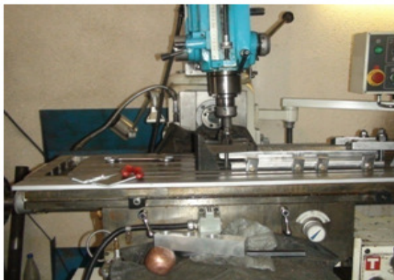
شکل (۲): فرز مورد استفاده برای آزمایش FSP
