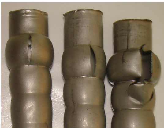
شکل (۴): نمونه بیلولهای پاره شده در فشار 135 bar
