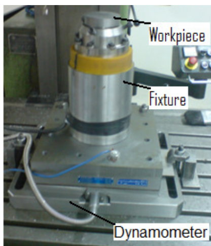
شکل (۳): نحوه قرار گیری فیکسچر و قطعه‌کار ساخته شده جهت انجام آزمایش‌های ارتعاشی بر روی دینامومتر
