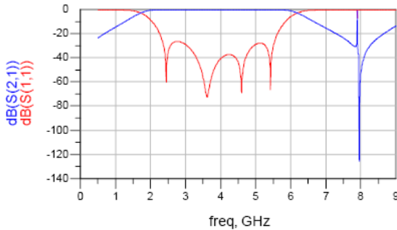
شکل (۱۱): نتایج تحلیل خط انتقالی فیلتر با چهار تزویج کننده
