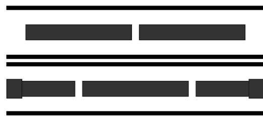
شکل (۱۰): شمای مدار چاپی در دو وجه لایه میانی فیلتر با چهار تزویج کننده
