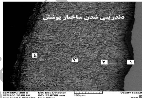
شکل (۴): ریز ساختار پوشش فولاد زنگ نزن ۳۱۶ درون روی مذاب ۱ غوطه ور شده به مدت ۱۲۰ ساعت در دمای ۴۵۸°C (با استفاده از میکروسکوپ الکترونی)
