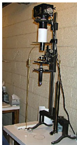
شکل ۴: نمائی از یک دستگاه میکروپروژکتور برای اندازه گیری قطر الیاف
