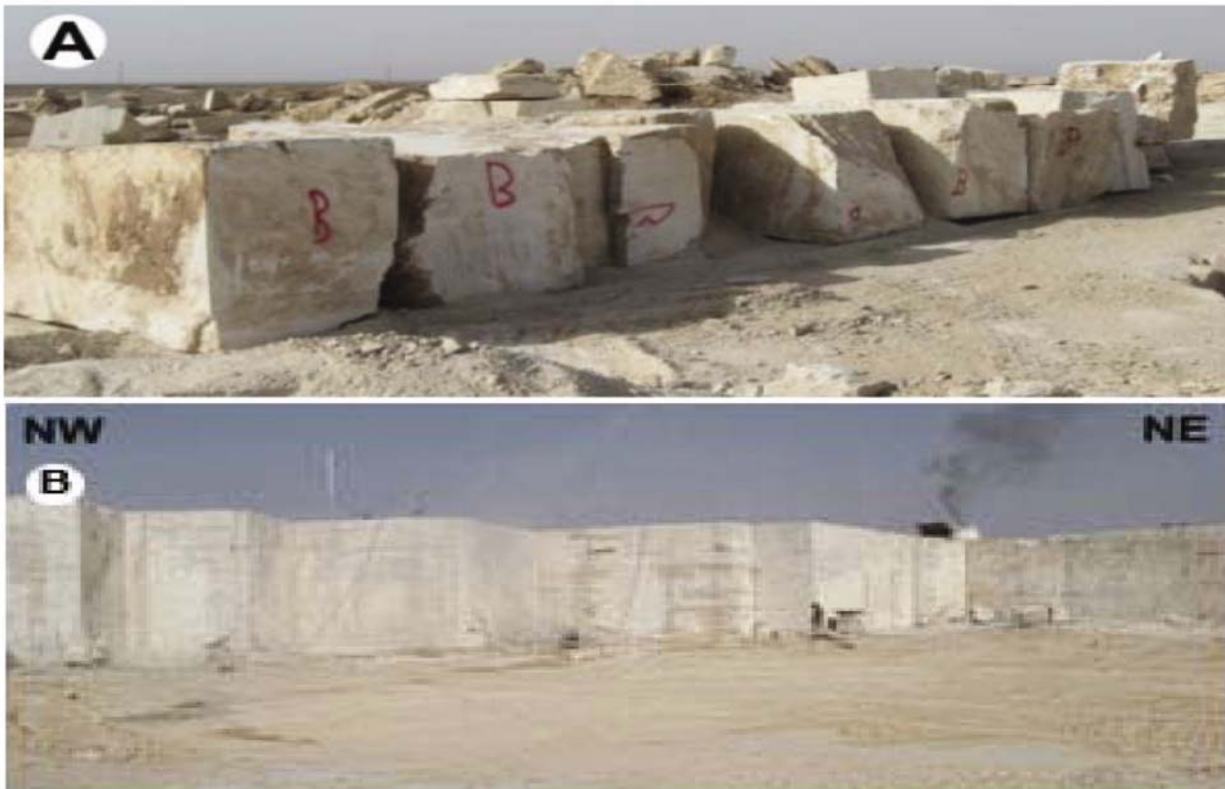
شکل ۳: A: کوپ های تراورتن استخراج شده در محل معدن سفید B: نمای کلی از معدن
