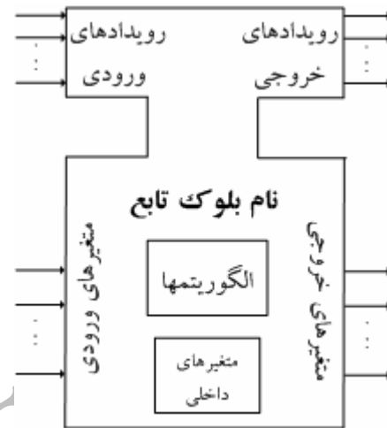
شکل (۱): نماد بلوک تابع و قسمت‌های مختلف آن
