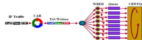
شکل ۴- مکانیزم CAR و WRED در مسیریاب براساس اولویت
