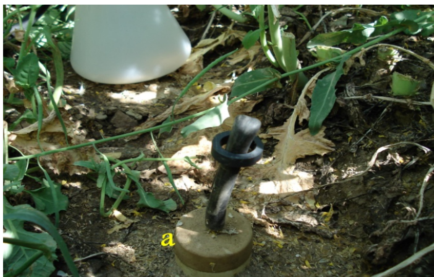
شکل ۱- (a) دستگاه Soil Water Sample برای تهیه نمونه زه‌آب.
