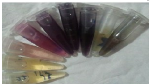
شکل ۲: تولید نانوذرات طلا به روش درون سلولی.
