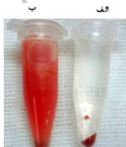
شکل ۲: تولید نانوذرات طلا به روش درون سلولی.
