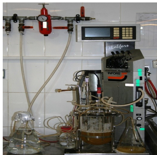
شکل ۱: بیوراکتور مورد استفاده در این تحقیق به منظور سولفورزدایی از فاضلاب.
