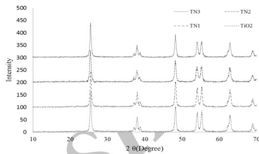
نمودار شماره ۱: طیف XRD نانو ذرات  $\text{TiO}_2$  و N-doped  $\text{TiO}_2$
