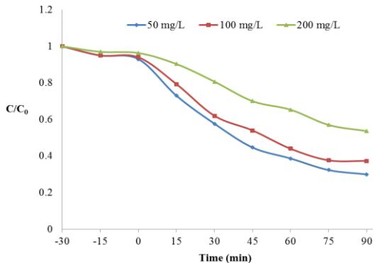
نمودار شماره ۶: اثر غلظت اولیه رنگ بر میانگین راندمان حذف رنگ در فرآیند سونو کاتالیستی  $\text{N-doped TiO}_2$  در زمان های مختلف ( $C_{\text{cat} 0} = 100 \text{ mg/L}$ ,  $\text{pH} = 3$ )
