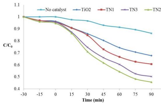
نمودار شماره ۴: اثر مقدار N-doped  $\text{TiO}_2$  بر میانگین راندمان حذف رنگ ( $C_{\text{dye} 0} = 100 \text{ mg/L}$ ,  $C_{\text{cat} 0} = 100 \text{ mg/L}$ ,  $\text{pH} = 3$ )
