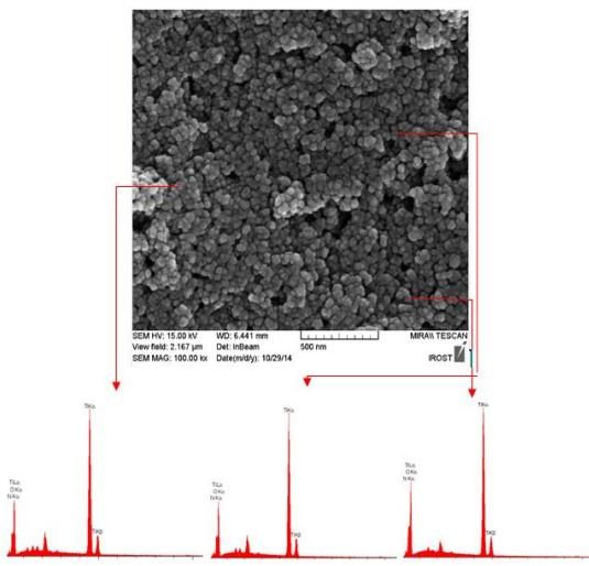
تصویر شماره ۱: تصویر FE-SEM همراه با EDX نانوذرات  $\text{N-doped TiO}_2$
