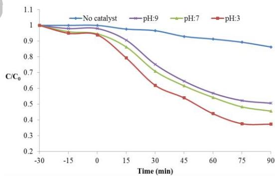
نمودار شماره ۵: اثر pH بر میانگین راندمان حذف رنگ در فرآیند سونو کاتالیستی  $\text{N-doped TiO}_2$  ( $C_{\text{cat} 0} = 100 \text{ mg/L}$ ,  $C_{\text{dye} 0} = 100 \text{ mg/L}$ )
