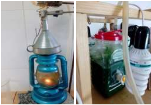
تصویر شماره ۱: ریزجلبک تولید شده در فتویوراکتور (راست) و قیف جمع آوری گاز حاصل از احتراق نفت سفید (چپ).
