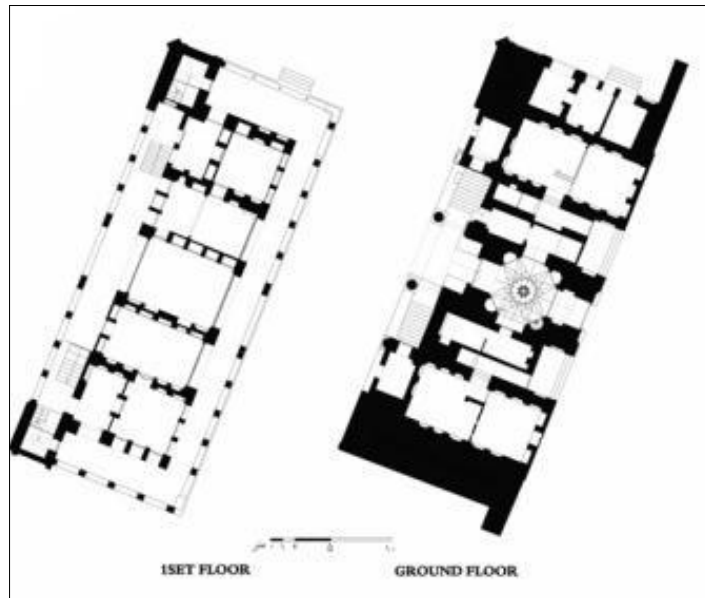
شکل ۵: نقشه اشکوب اول و دوم ساختمان سردر و هشتی ورودی سردر (آرشیو میراث فرهنگی کردستان، ۱۳۸۶).
