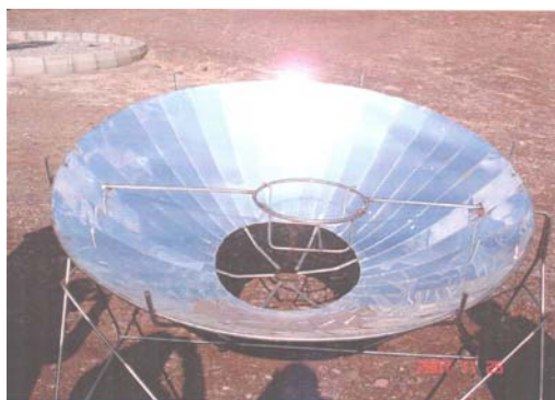
تصویر شماره (۶): نمایی از اجاق خورشیدی ساخته شده در
