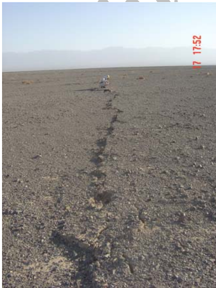
شکل (۱۱): نمونه‌هایی از شکستگی‌های برداشت شده مربوط به گسیختگی سطحی جدید در جنوب بم، ایستگاه ۳۹ (الف) و ایستگاه ۵۶ (ب). بالای تصویر (ب) به سمت جنوب است. در این تصویر یک فروافتادگی، حدود ۵ سانتیمتر، در سمت چپ (شرق گسل) به خوبی قابل مشاهده است.
