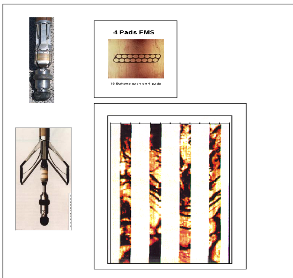
شکل ۳- نمای کلی ابزار تصویرگر FMS و نمایش الکتروود های آن به همراه تصویر دیواره چاه
