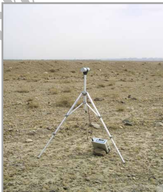
شکل ۶: محل ثابت قرار گرفتن دستگاه مغناطیس سنج و سه پایه
