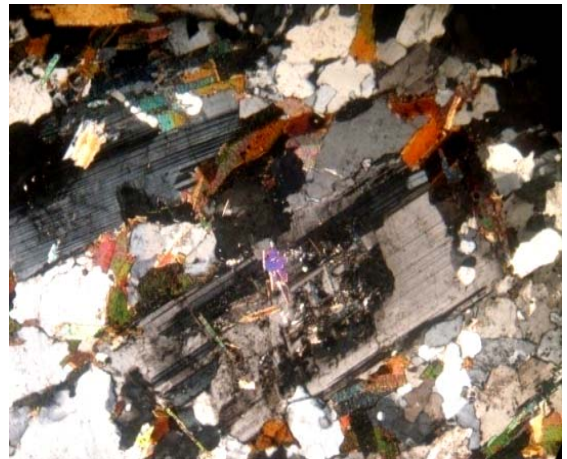
عکس ۷- دگرسانی پلاژیوکلاز با ماکل آلبیتی که به طرف مرکز سرسیتی شده است ودانه های ریز کوارتز و بیوتیت قابل مشاهده است. (X100, XPL).
