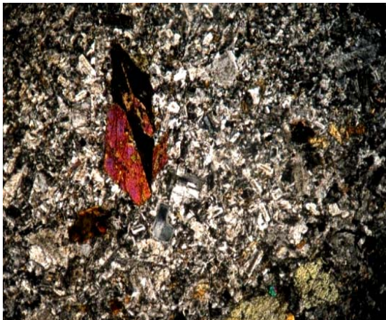
عکس ۹- هورنبلند با ماکل کارلسباد در زمینه ای از پلاژیوکلاز و کوارتز با بافت پورفیری در کوارتز دیوریت مشاهده می شود. (X40, XPL)
