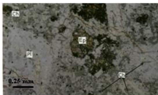
شکل ۱۲- دگرسانی پروپلیتیک . به گسترش تیغه‌های کلریت و دانه‌های اپیدوت بر روی پلاژیوکلازها و فضای بین آن‌ها توجه شود (XPL,X40)
