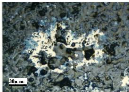
شکل ۱۹ - تبدیل شدگی کولیت به کالکوسیت در سطوح بالای منطقه غنی شدگی (XPL,X100)
