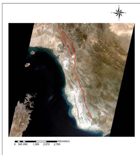
شکل ۲۸- تصویر شکستگی‌های ساختاری منطقه، روی تصویر ماهواره‌ای RGB = ۳۲۱ (خطوط قرمز محل عبور گسل را نشان می‌دهد)
