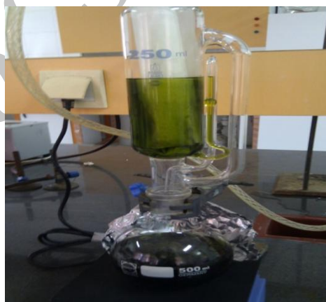
شکل ۱. فرآیند روغن‌گیری با استفاده از دستگاه سوکسله
