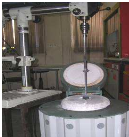
شکل ۲ سیستم ریخته‌گری ساخته شده در این پژوهش
