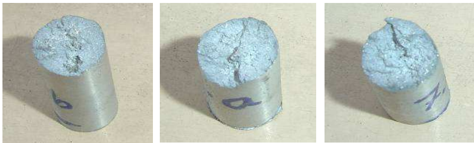
شکل ۶ برخی از نمونه های آماده شده برای بررسی سطوح شکست ناشی از آزمایش کشش در این پژوهش
