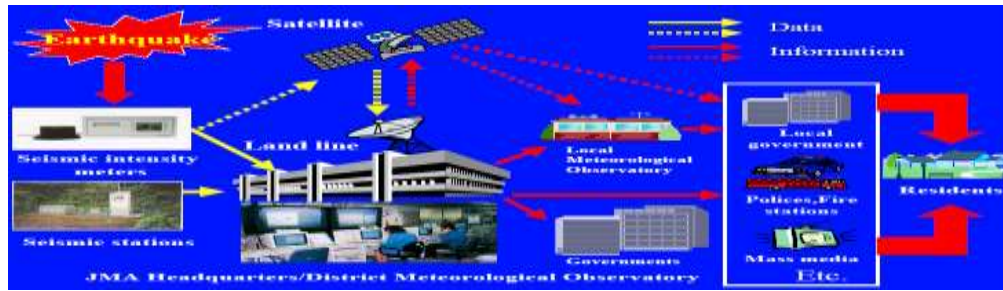
شکل سه: شماتیک انتقال داده لحظه‌ای هنگام بروز زلزله در شهر کوبه
