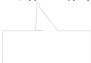
ج- شروع ترک در تاج سد در زمان t=4.978 sec
