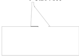
د- ورود پروفیل ترک به درون فونداسیون سد در زمان t=4.088 \text{ sec}
