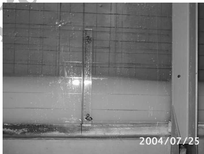
شکل (۲) - یک نمونه بدنه جریان چگال ایجاد شده در آزمایشگاه برای انجام تحقیق
