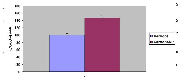
شکل-۳ مقادیر IC50 مربوط به کربوپلاتین و کربوپلاتین بارگذاری شده بر روی نانوذره PBCA. نتایج به صورت میانگین  $\pm$  ۵ درصد خطأ از حداقل سه آزمایش مستقل ارائه گردید.
