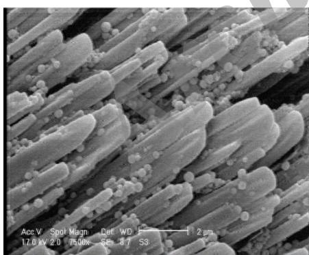
شکل-۱ میکروگراف میکروسکوپ الکترونی روبشی از نانوذره پلی بوتیل سیانوآکریلات بارگذاری شده با کربوپلاتین (بزرگنمایی ۷۵۰۰ برابر) تصاویر حاصل از این بررسی نشان داد نانوذرات بصورت کروی با سطحی صاف و بصورت مجزا می باشند. همچنین نانوذرات حاصل تقریباً همگن بودند. نتایج حاصل از بررسی میزان بارگذاری نشان داد که میزان بارگذاری دارو بر روی نانوذرات
