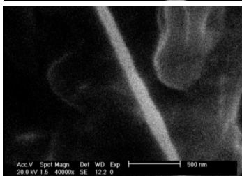
شکل ۸- تصاویر SEM نشان داده شده از الیاف باکتریال سلولز در بزرگنمایی های ۲۰۰۰۰ (تصویر بالا) و ۴۰۰۰۰ (تصویر پایین)
