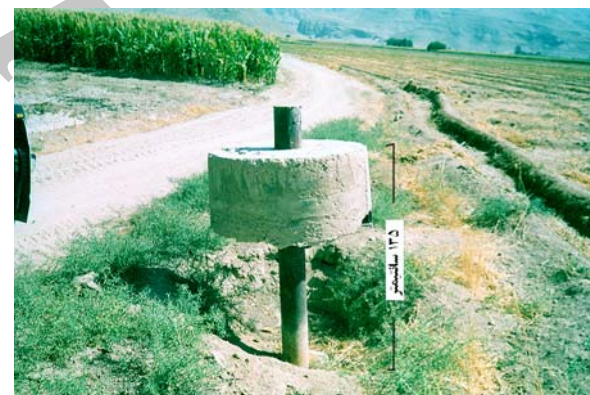
شکل ۴: ارتفاع یافتن میله فلزی چاه اکتشافی به اندازه ۱/۳۵ سانتیمتر در طی ۱۲ سال اخیر
