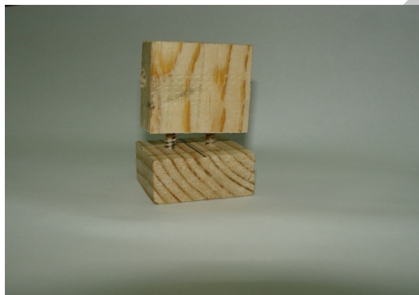
شکل ۷. نحوه شکست و جدایی در اتصال پیچ در بررسی مقاومت کششی
