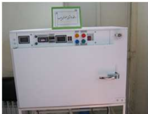
شکل ۱. دستگاه هوازگی مصنوعی (اختراع ثبت شده دکتر محمد رضا ماستری فراهانی)
