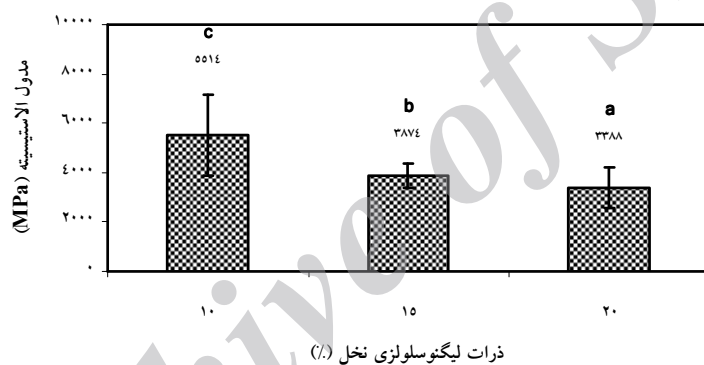
شکل ۵. تأثیر مستقل ذرات لیگنوسلولزی نخل بر مدول الاستیسیته چندسازه چوب‌سیمان
