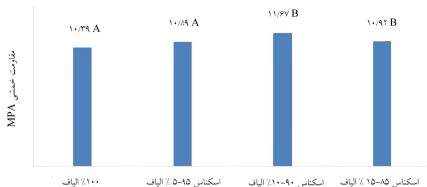
شکل ۱. اثر درصد اختلاط بر مقاومت خمشی به همراه گروه بندی دانکن
