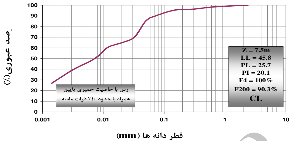
شکل ۲- نمودار دانه بندی نمونه تهیه شده از عمق ۷/۵ متر گمانه اول
