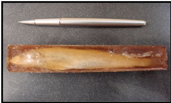
شکل ۲: ماهی شورت و تغییر رنگ در رزین در اثر فساد در نمونه
