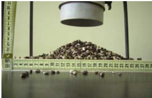
شکل ۳: تصویر گرفته شده توسط دوربین پس از تخلیه بذر از داخل سیلندر
