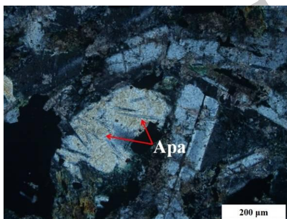
شکل ۱۰- تصویری از تیغه‌های آپاتیت به صورت میانبرهایی در بلور پلاژیوکلاز در سنگ میکروگابرویی (نور XPL).
