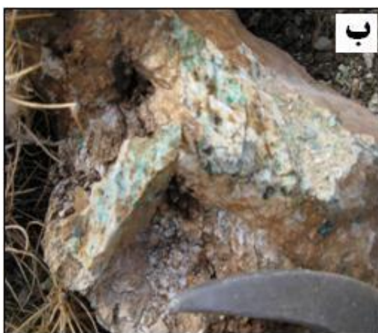
شکل ۶- ب) کانه‌زایی مس به صورت کالکوپیریت و مالاکیت در امتداد رگه‌های سیلیسی
