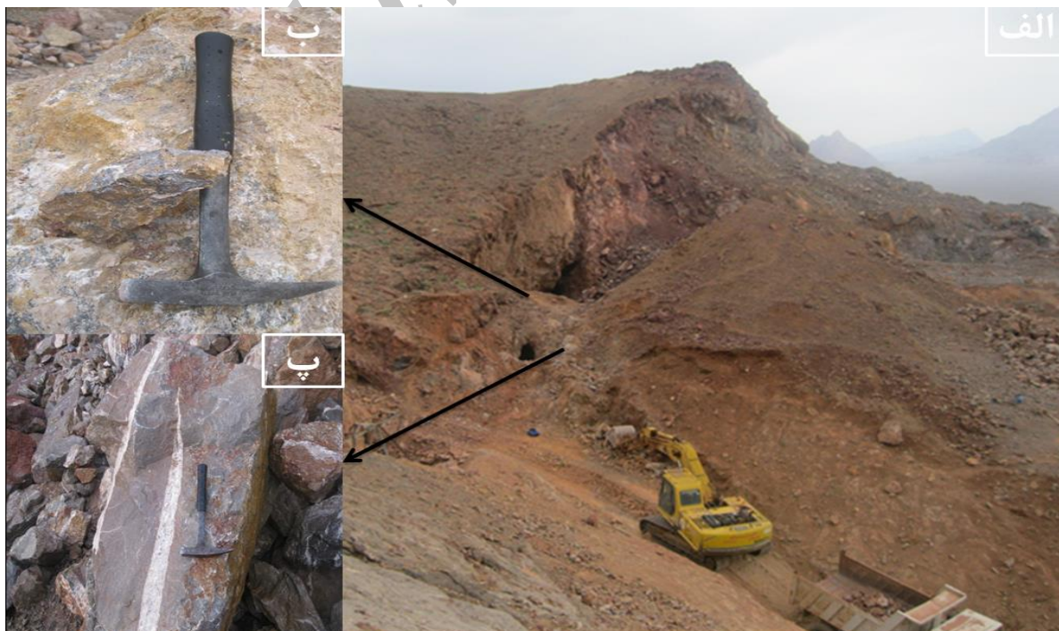
شکل ۷- الف- نمایی از حفر ترانشه در محدوده حوض سفید (دید به سمت شمال غرب)؛ ب- کانه‌زایی گالن بصورت جانشینی و پرکننده فضای خالی؛ پ- رگه کلسیت ثانویه در آهک خاکستری رنگ کرتاسه (سازند تفت)
