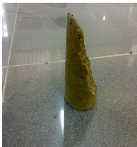
شکل ۲- نمونه شکسته شده رسی در ۱۰۰ درصد تراکم
