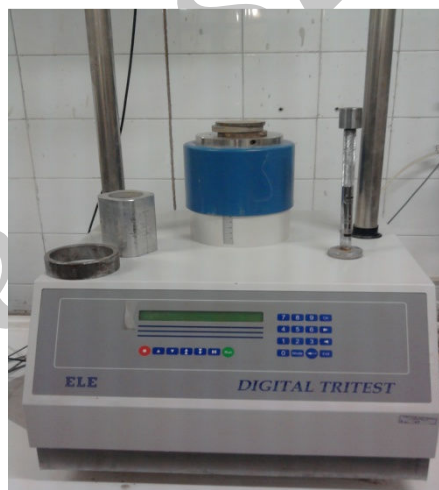
شکل ۱- وسایل ساخت نمونه و آزمایش تک محوری
