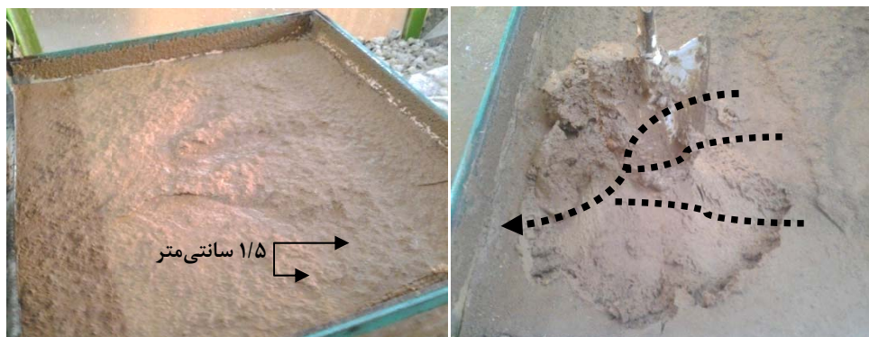
شکل ۷- شیباری شدن با الگوی پنجه‌ای در تیمارهای انجماد و ذوب (راست) و لایه یخ‌زده در عمق حدود ۱/۵ سانتی‌متر (چپ)
