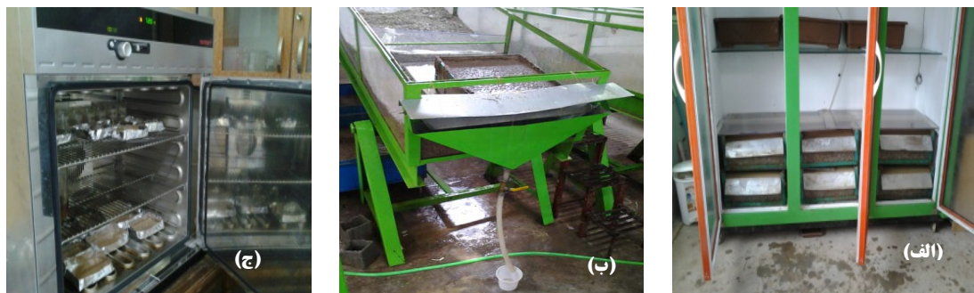
شکل ۱- نمایی از شرایط آزمایشگاهی ایجاد شده برای اجرای پژوهش شامل چیدمان کرت‌ها در سامانه سرمایشی (الف)، اجرای آزمایش شبیه‌سازی باران (ب) و اندازه‌گیری مقادیر رسوب (ج)
