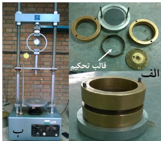
شکل ۲. قالب مخصوص (الف) و دستگاه ویژه بارگذاری (ب) برای تهیه نمونه‌های آزمایشی
