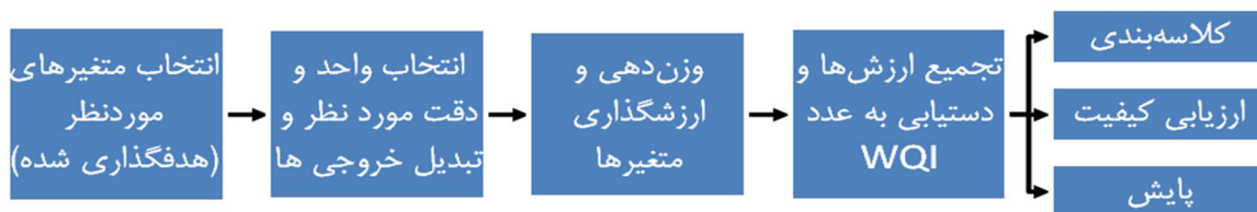
شکل ۲. فرایند انتخاب مدل شاخص-محور کیفی و خروجی‌های آن
